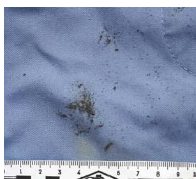
Рис. 5: а) след, образовавшийся с изнаночной стороны (левого) нагрудного кармана рубашки в результате взрыва петарды; б) запекшиеся, несгоревшие частицы пороха, образовавшихся по периметру основного следа
