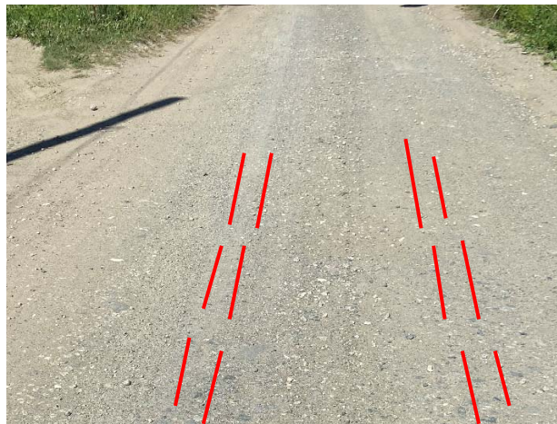
Рис. 3. Длина тормозного пути (юза) для автомобиля с ABS на грунтовой дороге (скорость 40 км/ч)
