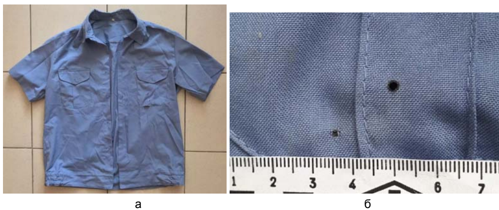
Рис. 4: а) форменная рубашка со следами применения ПС в области нагрудного кармана; б) два следа на лицевой части (левого) нагрудного кармана, образовавшиеся в результате взрыва петарды
