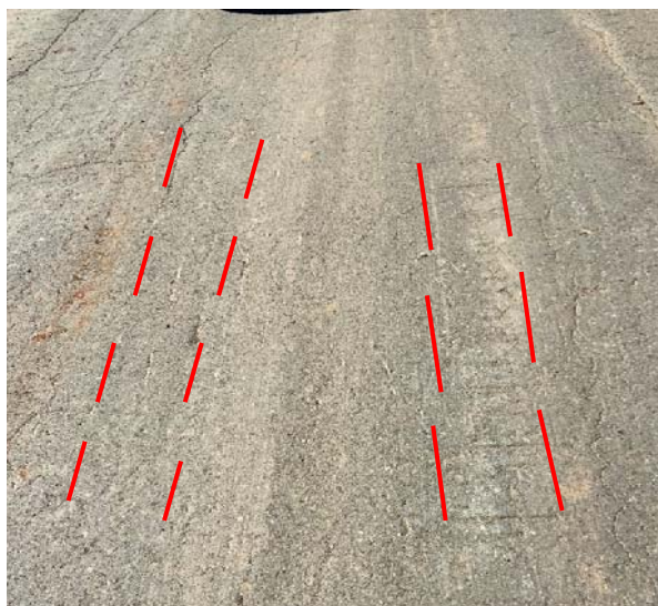
Рис. 2. Длина тормозного пути для автомобиля с ABS на асфальтовом покрытии (скорость 40 км/ч)
